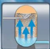
Sistema automático de retrolavado de filtros con indicador luminoso para válvulas de dimensiones 1 ½", 2" o 3".
