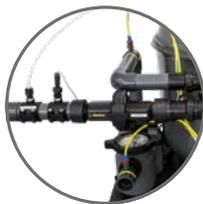
Le système Watercom VITALIA est déjà presque entièrement pré-monté. La tuyauterie de la pompe de filtration est déjà raccordée, de même que la cellule d'électrolyse avec le commutateur à palette. Le prélèvement et le retour de l'eau de mesure sont aussi installés, ainsi que le point d'injection pH-Minus.
