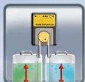
Перестальтические насосы dinodos START LEVEL BUS со встроенной системой измерения уровня реагента в канистрах(в см). Предупредительное сообщение через системную шину.
