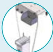
Die Konsolen werden mit Hilfe von Edelstahlplatten am Beckenrand befestigt, die unter der Beckenumrandung montiert sind.
