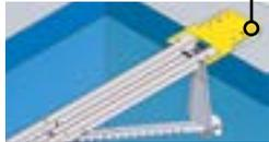
Die Stützwinkel für Nischenverkleidungen ohne Sturzbalken dienen zur Verlängerung des Randbelags über den Beckenrand hinaus und ermöglichen die Befestigung der Nischenverkleidung. Diese Lösung eignet sich besonders für hohe Wasserstände.
